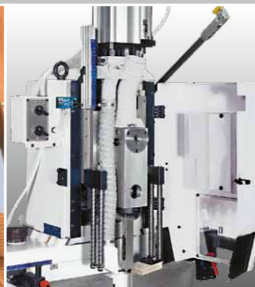
Particolare dell'unità porta-bedano. Detail de l'unité porte-bédane. View of chisel-holder unit. Detailansicht des Lochbeitelaggregates. Especifico de la unidad porta-herramienta bedano cuadro
